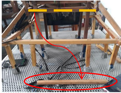
Gambar 5. Blander penggerak lambang gantung runtuh
