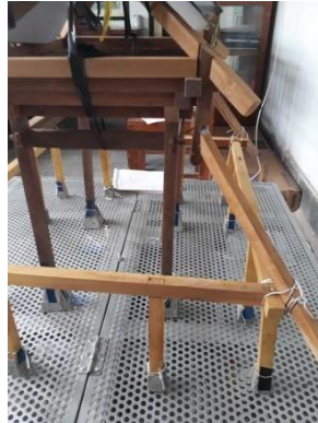
Gambar 3. Perlakuan Beban Atap dan Balok
