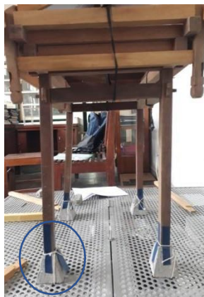
Gambar 2. Perlakuan Kolom dengan Umpak
