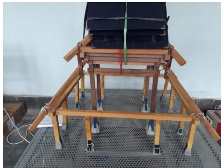
Gambar 1. Perlakuan Umpak dan ujung duduk dengan kolom
