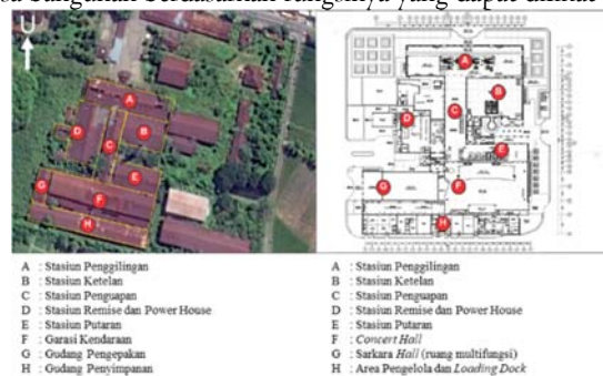
Gambar 1. Pembagian Blok Massa Bangunan Bekas Industri Pabrik Gula Colomadu Sebelum dan Sesudah Revitalisasi Sumber: Analisis Penulis, 2021
